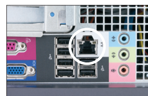
Port Ethernet w tylnym panelu CPU komputera stacji IDEXX VetLab
